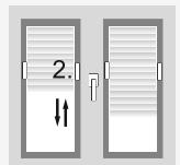
**Плавний ПІДЙОМ** - повний підйом / опускання жалюзі здійснюється за допомогою правої магнітної ручки (магнітна ручка вниз), опустити - (магнітна ручка вгору).
