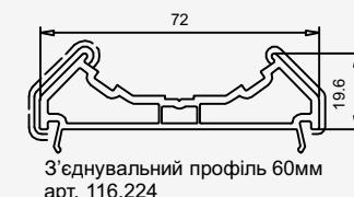
З'єднувальний профіль 60мм
